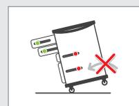
Pour éviter un risque de basculement, les servantes de la série 40 sont équipées d'un système d'ouverture unitaire des tiroirs.
