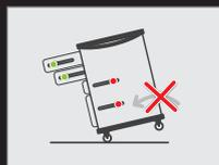
Pour éviter un risque de basculement, les servantes de la série 40 sont équipées d'un système d'ouverture unitaire des tiroirs.
