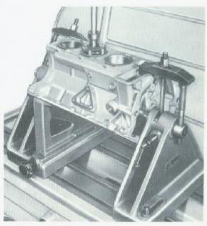
Fig. 3 - Smerigliatura canne cilindri.
