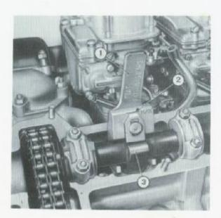
Fig. 2 - Registrazione giuoco punterie. 1. Attrezzo A. 60361 - 2. Riferimento per bloccaggio cursore di arresto - 3. Eccentrico albero distribuzione.
