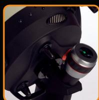
Des boutons immobilisent le miroir et le stabilisent lors des déplacements et des manipulations ou des orientations diverses lorsqu'il est assemblé sur une monture. Deux aérations filtrées (maille de 60 micron) mécaniques sont situées sur le barillet arrière pour accélérer la mise en température et s'adapter rapidement aux fluctuations de température au cours de la nuit en permettant à l'air chaud de s'évacuer près du miroir primaire sans déposer de poussière
