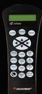
La raquette de contrôle permet de mettre à jour le logiciel de contrôle par téléchargement via Internet
