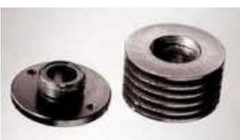
Radiateur pour boîtier TO220 (triac type TIC226 ou régulateur de tension type LM7805 par exemple), modèle ML24, Rth = 17°C/W. Modèle assez typique et très utilisé.
