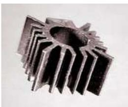
Radiateur pour boîtier TO5 (transistor 2N2219 par exemple), modèle CO180, Rth = 28°C/W. Au vu de la résistance thermique de ce radiateur, on voit tout de suite que le refroidissement sera meilleur qu'avec le ML61, présenté juste avant.
