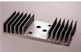
Radiateur pour deux boîtiers TO3 (2N3055 par exemple), modèle ML25 double, Rth = 2,4°C/W
