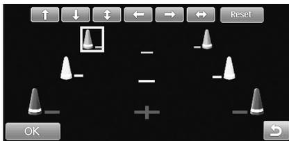
**3 Effleurer [↑], [↓], [←] ou [→] pour régler la position de la ligne de guidage.**
