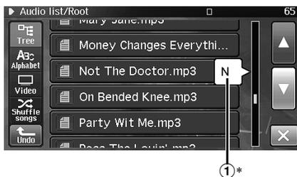
Il existe trois niveaux progressifs de vitesse de défilement. Au premier niveau, lorsque l'effleurement est maintenu, la liste défile à raison de quatre lignes par seconde. Lorsque l'effleurement se prolonge, la liste défile à raison de huit lignes par seconde. Lorsque l'effleurement se prolonge encore, la liste défile à raison de 40 lignes par seconde.
