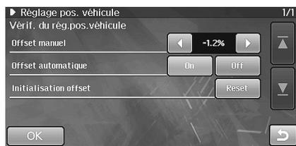
Lorsque le déplacement de la position actuelle sur la carte retarde par rapport au déplacement réel, effleurer [▶] pour étalonner. Lorsque le déplacement sur la carte est en avance, effleurer [◀] pour étalonner.
